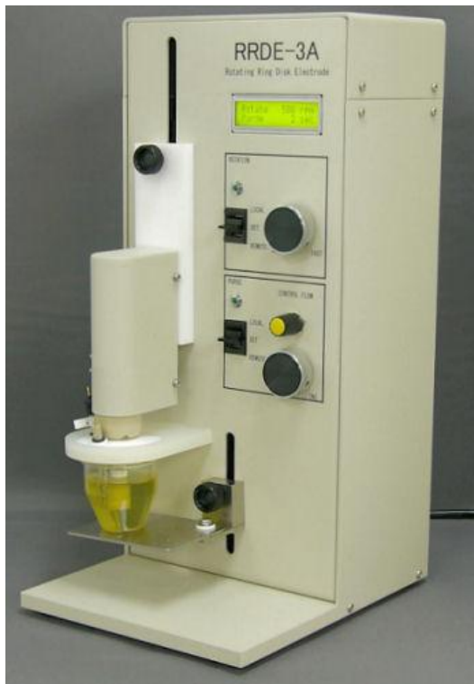
Fig. 58: ALS-RRDE-3A Rotating Disk electrode
