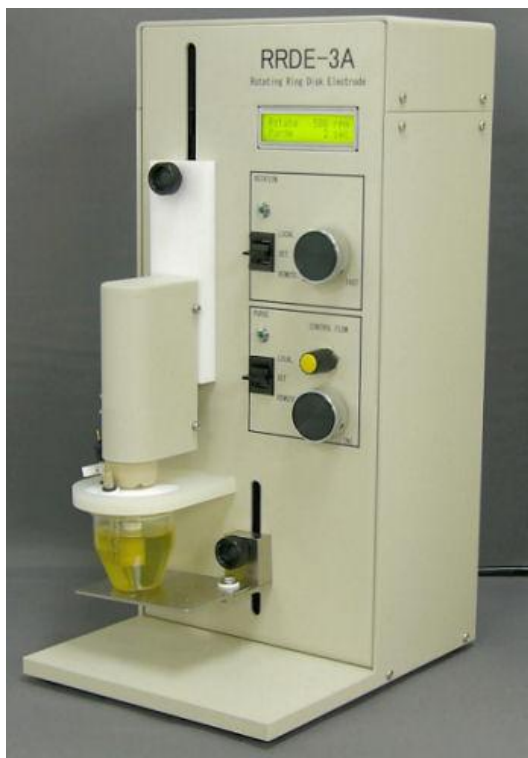
Fig. 56: ALS-RRDE-3A Rotating Disk electrode
