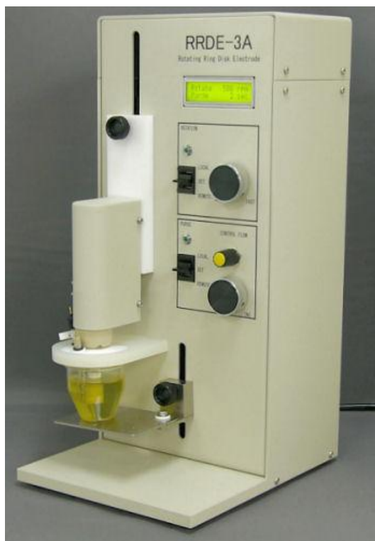
Fig. 55: ALS-RRDE-3A Rotating Disk electrode
