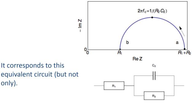
With  $R_1$ : Ohmic drop  $R_{\Omega}$ ;  $C_2$ : Double layer capacitance  $C_{dl}$  $R_2$ : Charge transfer resistance  $R_{ct}$
