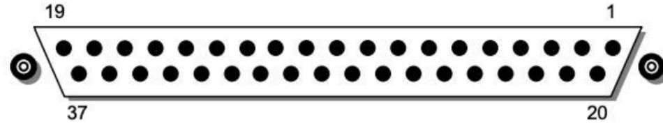
Figure vi. The DB37 TTL I/O connector.
