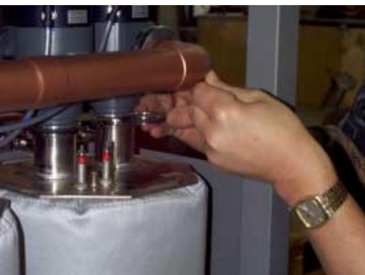
Ventile und Verrohrung leicht anheben, Zentrierringe mit O-Ringdichtung bei beiden Flanschen vorsichtig herausnehmen.
