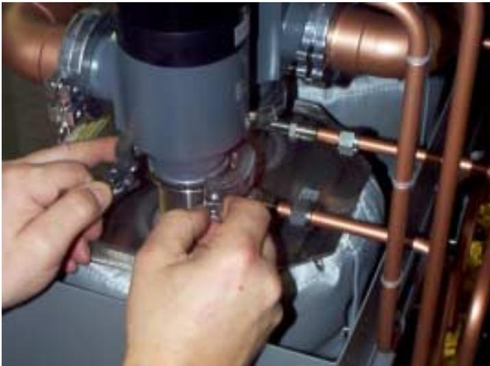
Schraubverbindungen an beiden Flanschen lösen
