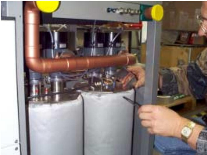
Schutzkästchen für elektrischen Anschluß entfernen.
