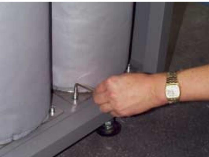
Alle 4 Bodenverschraubungen lösen.
