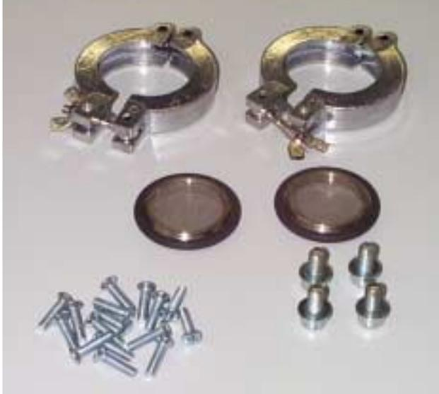
Überprüfen des demontierten Materials auf Beschädigung oder Verunreinigung, ggf. Reinigen oder austauschen.
